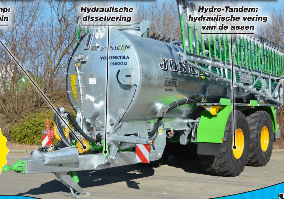
PENDSLIDE PRO 150/60PS2 verspreidingsboom van 15 m
